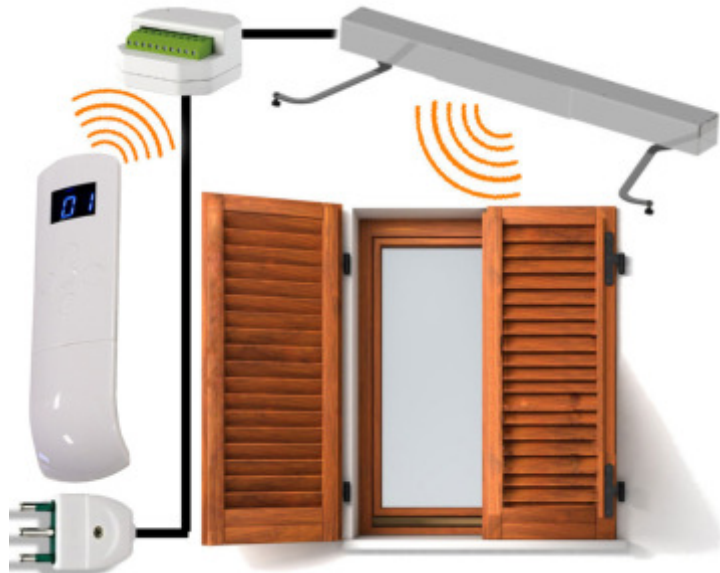
SCHEMA DI PRINCIPIO IMPIANTO ELETTRICO CON COMANDO RADIO
